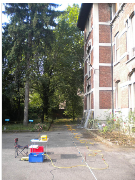
Foto 3 : stendimento sismico MASW realizzato
