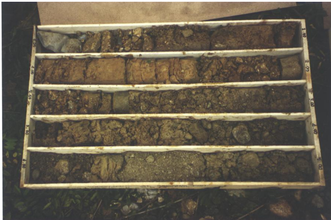
S1 = Cassetta catalogatrice da 0 a 5.0 m
