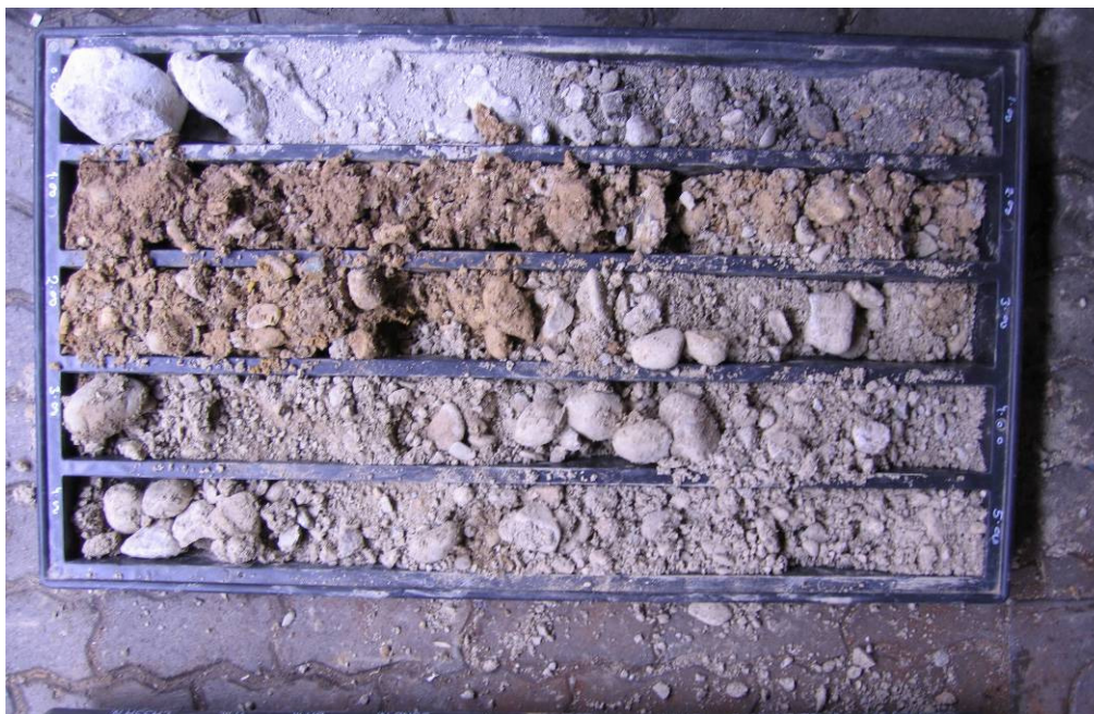
S3 = Cassetta catalogatrice da 0 a 5.0 m
